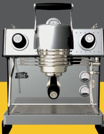
**TECNOLOGÍA PATENTADA** El exclusivo sistema de regulación digital de flujo DFR (Digital Flow Regulation) patentado permite gestionar electrónicamente el flujo de agua en cada fase de la extracción. La válvula de apertura se puede configurar digitalmente en centésimos de milímetro y se puede modular la preinfusión partiendo realmente de cero bar.
