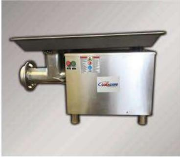
“ Los molinos COBACORP están fabricados en acero inoxidable en charola y gabinete, cabezal en acero estañado, tienen la capacidad de molienda hasta 1,000 Kg/hr. Gracias a su diseño nuestros molinos se pueden desarmar con facilidad sin necesidad de herramientas especializadas para una limpieza más profunda. ”
